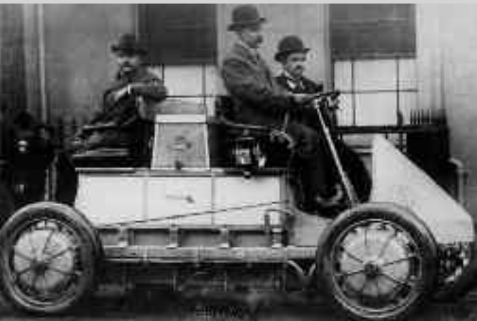
Elektrische Voiturette System Lohner-Porsche Baujahr 1900. Holz-Chassis sowie -Karosserie.
