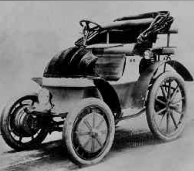
Elektrische Voiturette System Lohner-Porsche Baujahr 1900. Holz-Chassis sowie -Karosserie.
